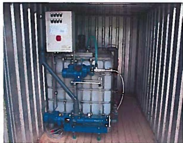
**Přemístitelný pytlový odvodňovač**
